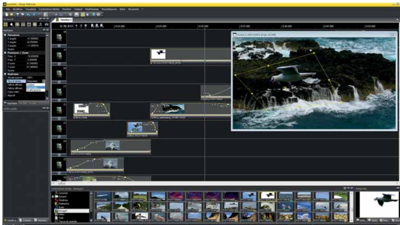
Figura 2 - Un momento di montaggio, quando si sta lavorando sull'immagine del gabbiano visibile anche a destra in basso, in anteprima della lavagna luminosa. Le immagini editate sullo schermo sono provviste automaticamente di traccia di controllo (barra gialla sotto la foto) e keyframes. Questi sono dei punti o nodi che contengono i valori per i parametri che influenzano l'immagine, come la dimensione, posizione e rotazione dell'immagine in quel punto. Nello schermo di lavoro si nota che la foto del gabbiano (file PNG trasparente) ha una forma sghemba (quadrilatero giallo) a causa di una rotazione 3D. A sinistra ci sono tutte le caratteristiche di quella foto e del keyframe su cui è posizionato il locatore (linea gialla verticale a 31 secondi della timeline); si noti la tendina per scegliere il tipo di keyframe, ossia l'andamento netto o morbido del movimento. Tutto quello che serve in quell'istante è a portata di mouse, con cui si fa tutto o quasi.
