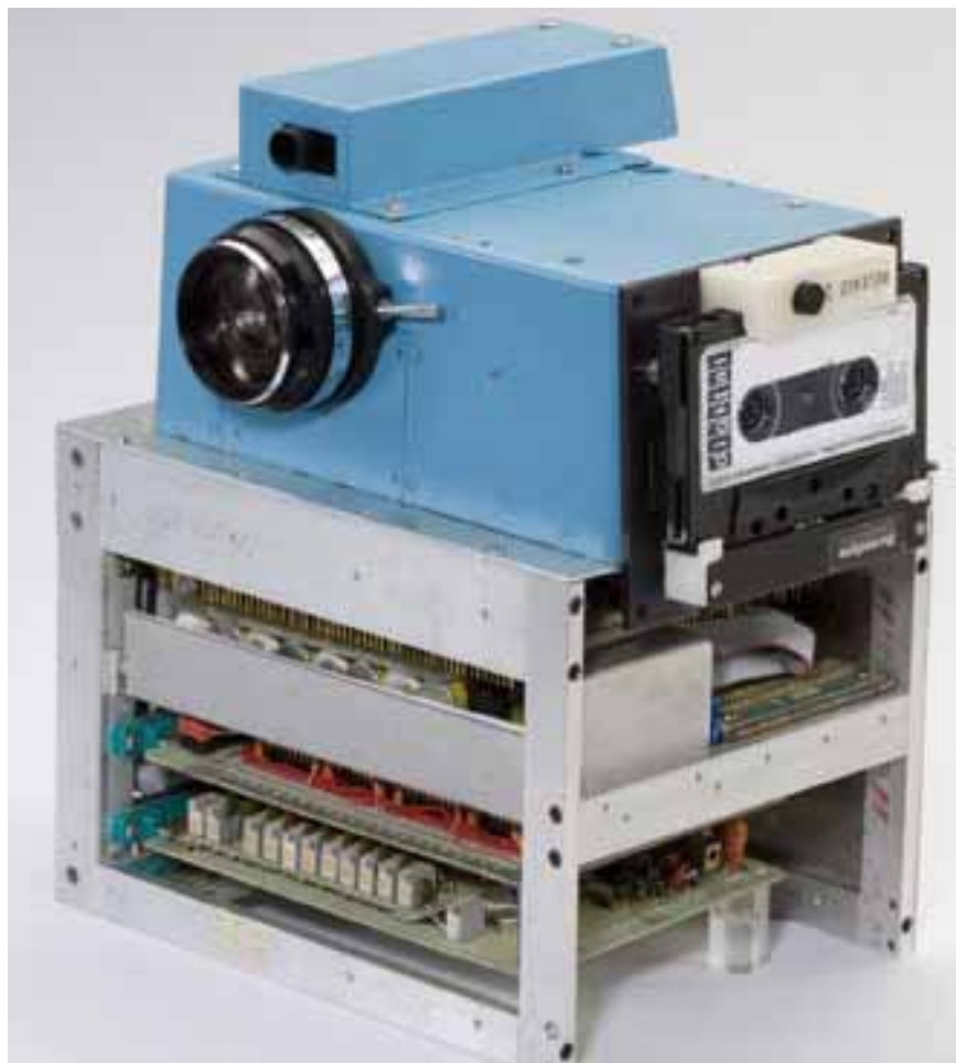
Figura 1 - L'attrezzatura realizzata da Stephen Sasson nel 1975 nei laboratori Kodak. Con quella realizzò la prima immagine digitale usando il sensore da lui inventato.
