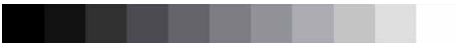
Figura 8 - Nella versione definitiva proposta da Ansel Adams, ciascuna delle 11 zone ha un unico tono, per evidenziare e semplificare il ragionamento, oltre che per avere campioni grigi di riferimento. A monitor, se di buona qualità, le tre zone più scure sono distinguibili; in stampa probabilmente no.
