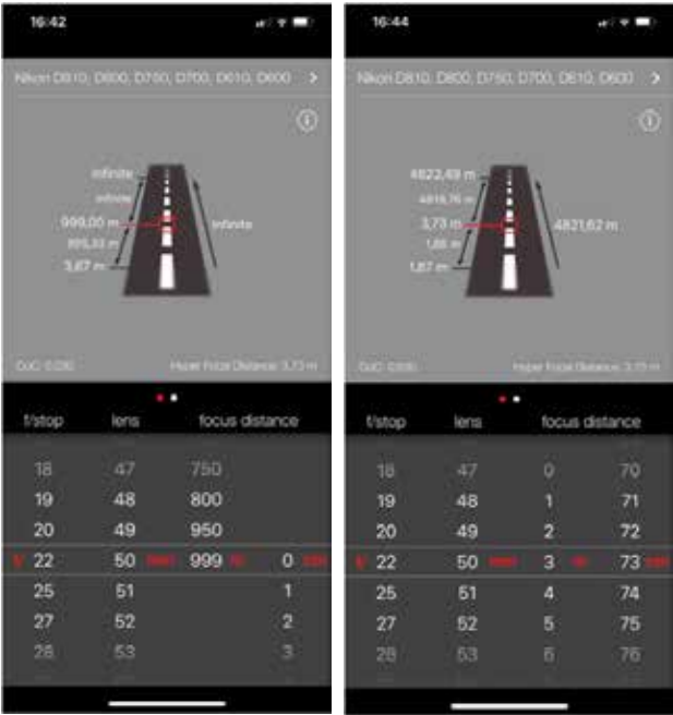
A sinistra, con messa a fuoco sull'infinito (con un 50 mm ad f/22) si ha una distanza iperfocale di 3,67 m. Se mettiamo a fuoco sull'iperfocale, la profondità di campo inizia comunque solo a 1,87 m dalla macchina.
